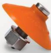
AIRATOR, akışkanlığı az olan toz malzeme uygulamalarında silo veya bunker altından toz malzeme kolayca akması için hava'nın akışkanlaştırıcı etkisi ile tıremes olusurma etkisini birleştirerek çalışır. Özel tasarım sayesinde Airator, silo veya bunker'ın iç duvarı üzerinde hava akışı oluşturduğunda hem tıremes hem de bir hava yastığı meydana gelir ve bu sayede toz akışkan hale gelerek blokaj çözülmektedir.
